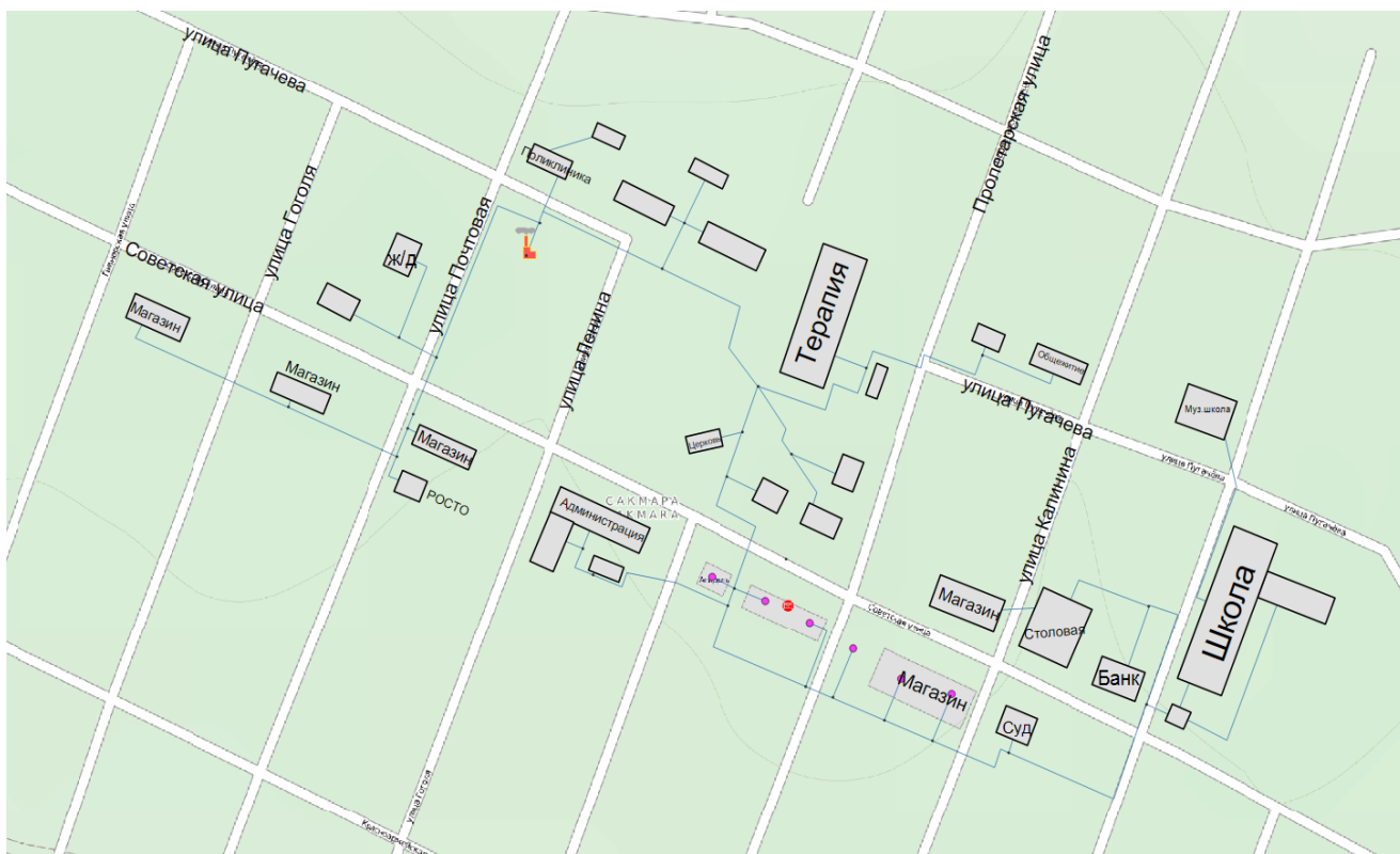
Рисунок 2.1 – Схема теплотрассы котельной МО Сакмарский сельсовет (Котельная по ул. Набережная, 8А с. Сакмара)
